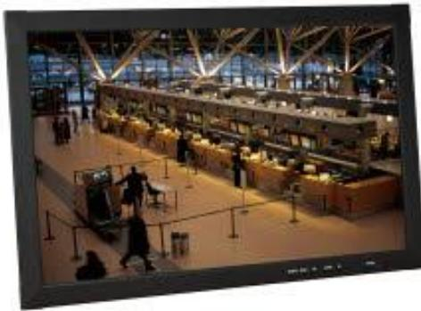
Der Monitor hat einen direkten SDI Videoeingang (BNC mit Durchschleif-Ausgang). Eine Kamera kann direkt angeschlossen werden. Sollen andere Monitore verwendet werden, so müssen sie in der Auflösung 1080p fähig sein, einen HDMI-Videoeingang haben und es muss ein SDI-HDMI Konverter eingesetzt werden.
